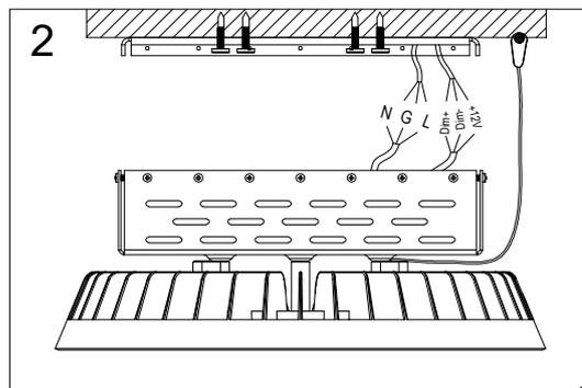
2. Connecter la ligne AC et les fils d'ajustement de la lumière (gradation), puis fixer les vis autour du boîtier d'alimentation.
