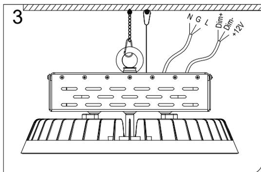
3. Connecter le câble AC. L pour la ligne "phase", N pour "neutre" et G pour la mise à la terre. Ajuster la lumière avec les fils positif et négatif. (Gradation)
