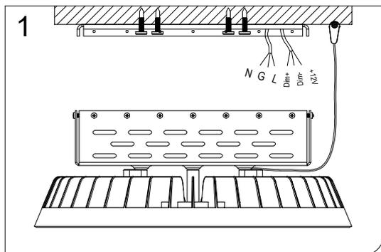
1. Retirer le couvercle du boîtier d'alimentation de la lampe, fixer le couvercle du boîtier d'alimentation au plafond avec des vis, et fixer également le fil de sécurité au plafond.
