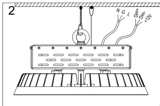
2. Fixer la chaîne et le fil de sécurité à l'endroit approprié, ajuster le niveau et la hauteur du luminaire.
