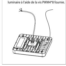
2. Percer 5 trous sur le plafond en se basant sur le diamètre de l'image de l'ancrage en plastique fourni, afin qu'ils correspondent aux trous de la fixation.
