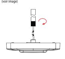
2. Tourner le filetage 3/4 "NPT pour le fixer avec la lampe, et fixer le NPT avec la vis fournie.
