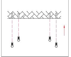
4. Visser le câble de sécurité et fixer l'appareil au plafond à l'aide de vis à tôle.
