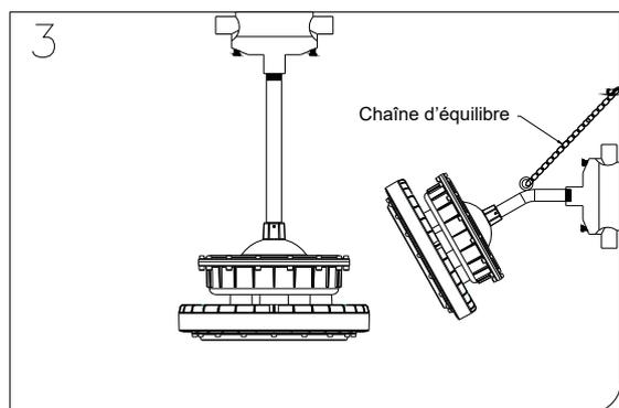
3. Installer la boîte de jonction au mur ou au plafond comme sur la figure 3. Visser le conduit à la boîte et ajuster la chaîne d'équilibre.
