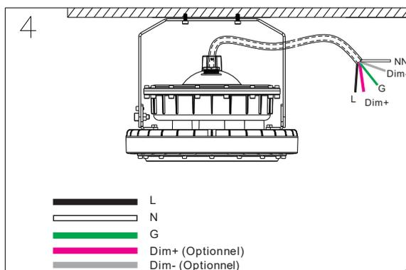
4. Connecter le câble AC de la source de courant, le noir au L, le blanc au N, le vert au G, le mauve au Dim+ et le gris au Dim-.
