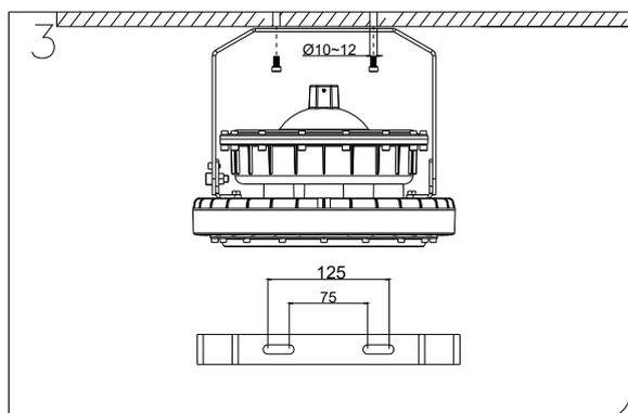
3. Percer 2 trous comme la figure 3, la distance peut être entre 75 et 125 mm, fixer le support au plafond avec des vis d'expansion Ø10~12.
