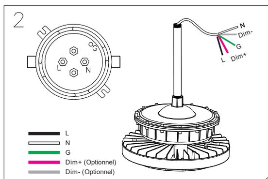
2. Connecter le câble AC de la source de courant, le noir au L, le blanc au N, le vert au G, le mauve au Dim+ et le gris au Dim-.
