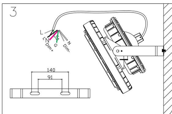
3. Percer 2 trous comme la figure 3, la distance peut être entre 91 et 140 mm, fixer le support au plafond avec des vis d'expansion Ø10.
