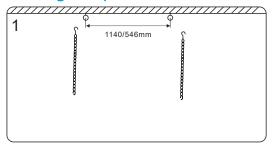
1. Percer 2x trou pour accrocher l'anneau (1140mm pour le montage de 4pi ou 546mm pour le montage de 2pi) et les fixer.
