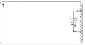
1. Percer 2x trou Ø15 pour les vis d'expansion, et les fixer au mur. (distance horizontale: 171mm)
