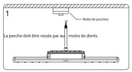
1. Passer le câble à travers le poteau et installer le luminaire au poteau.
