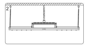
2. Fixer la chaîne de suspension au luminaire. Passer le câble à travers le conduit métallique et le connecter à la puissance.
