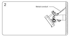
2. Installer le luminaire au mur et connecter le fil au courant alternatif. (le conduit en métal doit être appliqué ici)
