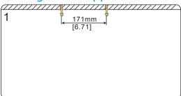
1. Percer 2x trous ø15 pour les vis d'expansion et les fixer au plafond.
