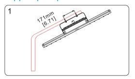
1. Percer 2x ø15 trous pour vis de fixation.
