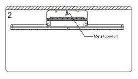
2. Installer le montage sur les vis d'expansion et serrer les écrous. (le conduit en métal doit être appliqué ici)
