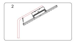
2. Fixer la chaîne de suspension et accrocher l'appareil. Insérer 2x vis Ø15 et les serrer sur le support du poteau avec le luminaire.
