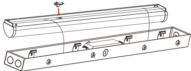
3. Connecter le fil du capteur au fil du boîtier d'alimentation
