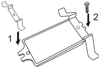
2. Installer le capteur dans la lentille.
