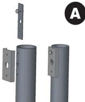
**A** Étape 1 - Installer la plaque arrière et l'adaptateur de support sur le poteau à l'aide des boulons, écrous et rondelles supérieurs. (Figure A)
