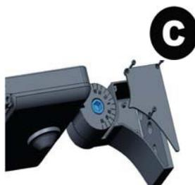
Étape 4 - Aligner les trous inférieurs du luminaire et de la plaque arrière avec le trou le plus proche du poteau, installer le boulon inférieur et serrer les deux boulons.
