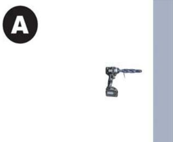
**A** Étape 1 - Percer deux trous dans le mur ou le plafond. (Figure A)
