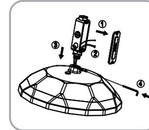
1. Retirer le couvercle, enfiler le fil dans la boîte de jonction et serrer la boîte à bornes et la vis de blocage.
