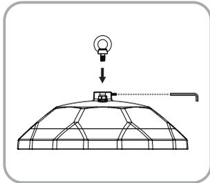
1. Fixer l'anneau au luminaire (tourner dans le sens des aiguilles d'une montre), serrer la vis.
