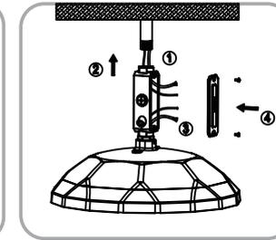
2. Enfiler le fil dans la boîte de jonction, installer la boîte de jonction sur le tuyau, câbler selon les exigences, prendre les mesures de protection et verrouiller le couvercle.
