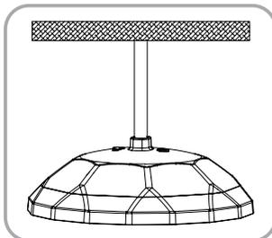
2. Tourner le luminaires vers le tube de montage (dans le sens dans le sens des aiguilles d'une montre).
