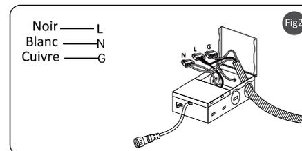
3. Insérer la boîte de jonction dans le trou de montage et la fixer, connecter le câble d'alimentation du luminaire à la boîte de jonction. Sélectionner la température de couleur désirée à l'aide du commutateur CCT, voir fig. 3.
