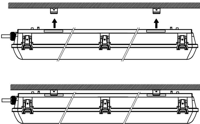
1- Luminaire étanche à l'eau et la poussière . Degré de protection IP66.
