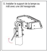
Note: - Le diamètre maximum du mât est de Ø60 L'ajustement de l'angle est de 0 à 90°
