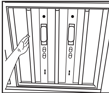
2. Retirer le ballast et les tubes fluorescents.
