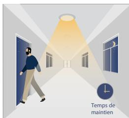
Après qu'il n'y a plus de mouvement détecté, le capteur garde la lumière allumée à 100 % pendant temps de maintien.
