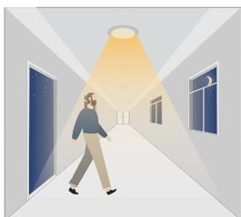
Avec insuffisamment de lumière ambiante, le capteur allume la lumière quand un mouvement est détecté.
