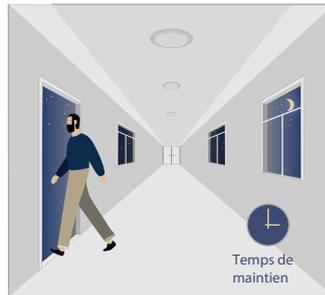
Le capteur éteint la lumière automatiquement après le temps de maintien lorsqu'aucun mouvement n'est détecté.
