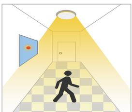
Lorsqu'un mouvement est détecté, le capteur allume la lumière à 100 % de sa luminosité.
