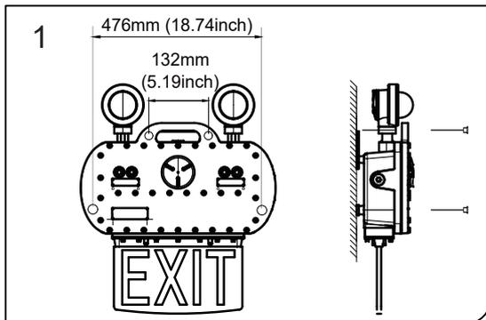
1. Percez quatre trous comme sur la figure 1, à une distance de 476 mm et 132 mm.
