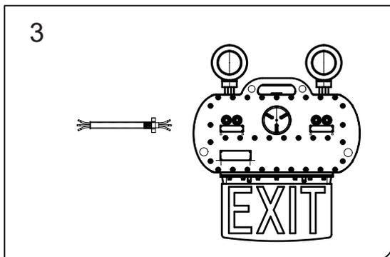
3. Installez le tuyau à l'entrée 3/4" NPT et fix 16mm (0.63inch) Chico A. Puis connectez le câble CA : le câble noir se joint à L, le câble blanc se joint à N, le câble vert se joint à la mise à la terre.
