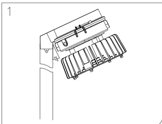
1. Installer le projecteur sur le mât fixé. Veiller à ce que le filetage du mât de la lampe soit adapté (NPT 1-1/2).
