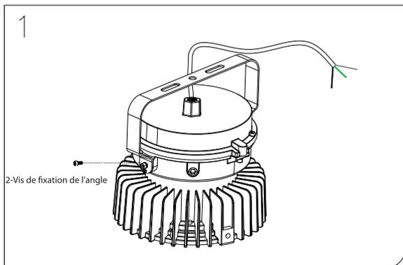
1. Sortir l'appareil et les accessoires de la boîte de carton, serrer deux fois la vis du support d'angle comme indiqué sur la Fig.1.
