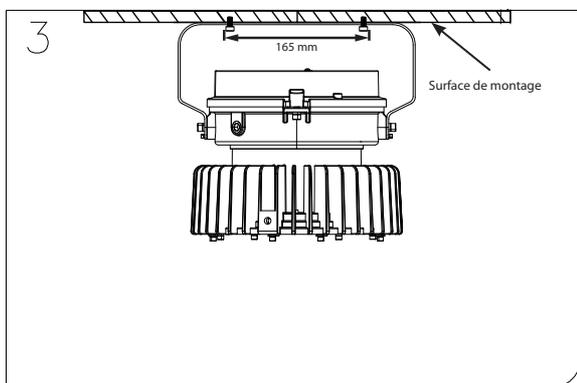
3. Percer 2 trous comme sur la figure 3, la distance recommandée pour le support de montage en surface est de 165 mm.
