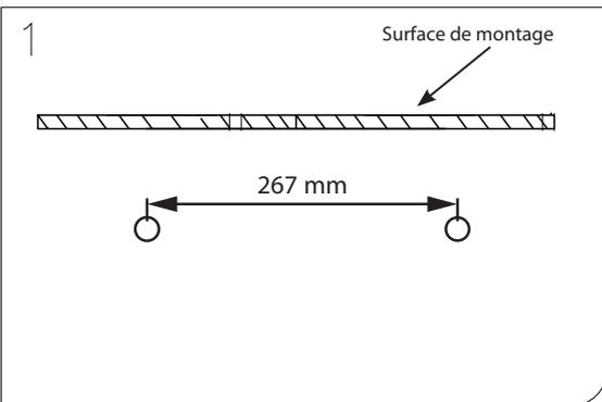
1. Marquer la surface de montage pour l'emplacement du matériel de montage comme indiqué sur la figure 1. La distance recommandée entre les supports de montage en surface est de 267 mm (Fig.1).
