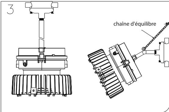
3. Installer le boîtier d'installation au mur ou au plafond comme indiqué à l'illustration. Serrer le poteau au boîtier, et ajuster la chaîne d'équilibre.
