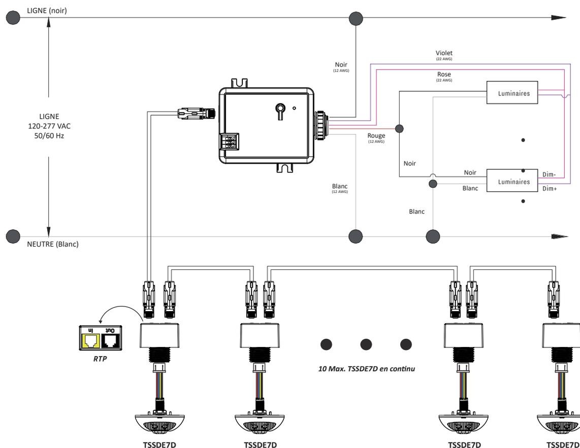
Remarque : charge maximale PPA104S 20 A, courant absorbé max. 48,5 mA du port de gradation.
